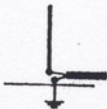
Obr. 5. Uzemnění vertikální antény
